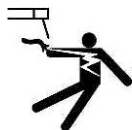
Nevarnost električnega udara.
