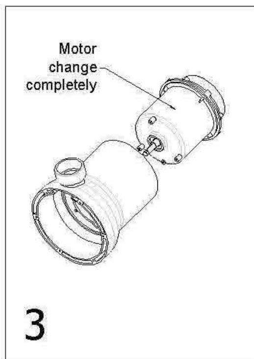
Slika 3 → Motor se menja kompletno
