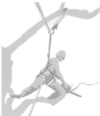
SB3 - Primer preusmeravanja glavne linije preko dodatnog ankera
