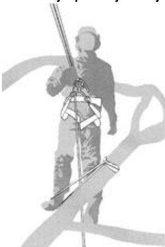
SB3 - Primjer preusmjeravanja glavne crte preko dodatnog ankera
