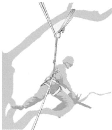
SB3 - Primer preusmeritve linije rezanja s pomočjo dodatne točke pritrditve
