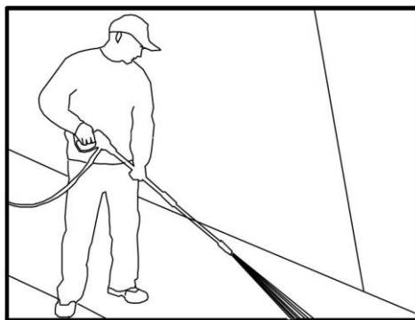
Фигура 6 – Оптимален ъгъл за почистване на повърхността
