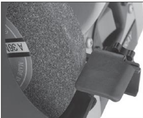
Slika 2. Nameščeno stojalo in nastavljeno na ustrezno oddaljenost od koluta
