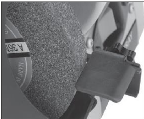
Фигура 2. Монтирана и настроена стойка наблизко до шлифовъчния диск.
