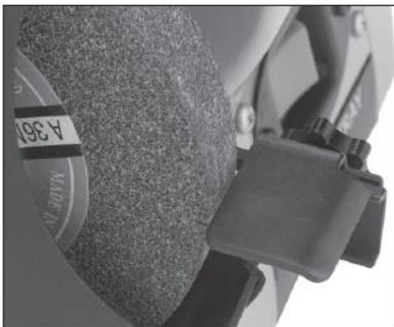
Imaginea 2. Suportul instalat și așezat în apropierea roții se polire
