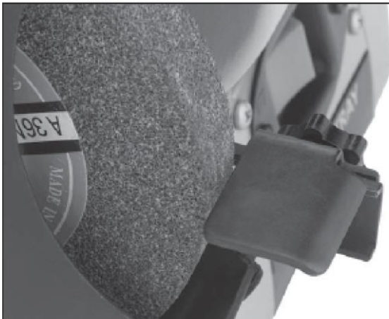
2. ábra. Az állványt a csiszoló korong g közelében helyezze el
