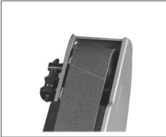
Slika 4. Brusni trak je nameščen na sredino valja in je enakomerno oddaljen od robov valja
