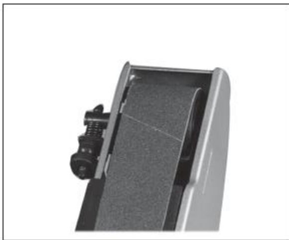
Imaginea 4. Cureaua de șlefuire așezată central între marginea capacului pentru cure ape șurubul superior
