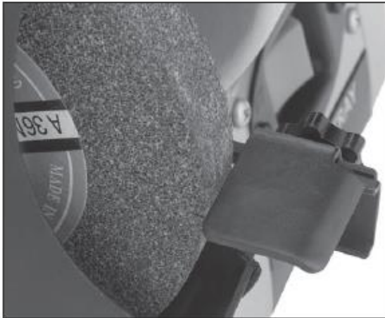
Obrázok 2. Podstavec nainštalovaný a zmontovaný blízko brúsneho kotúča
