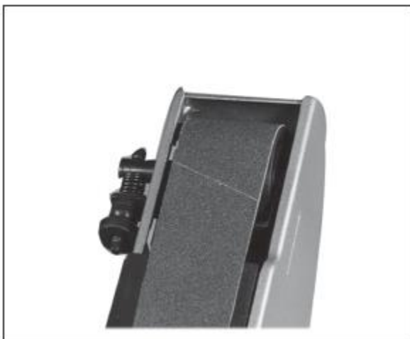
Фигура 4. Шлифовъчната лента е поставена централно между краищата на капака за лентата на горния валеж
