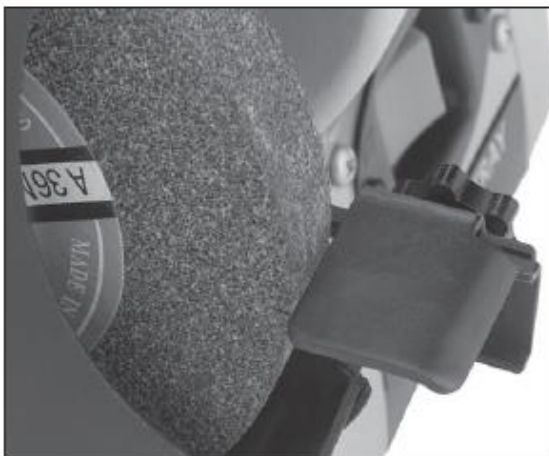
Слика 2. Постолје инсталирано и поставено во близина на брусното тркало
