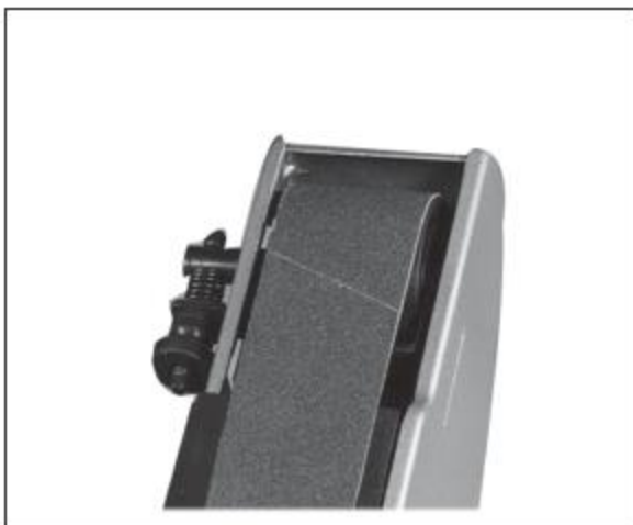
Slika 4. Brusna traka postavljena centralno između ivica poklopca za traku na gornjem valjku
