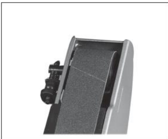
Слика 4. Лентата за брусене поставена централно помеѓу рабовите на капакот за лентата на горниот валец
