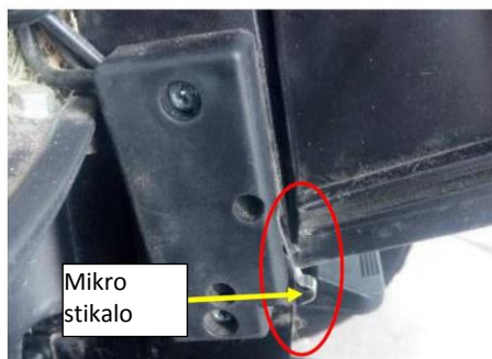
Slika 14-1 Mikro stikalo – odprto
