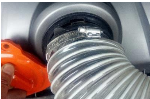
Slika 12-2 Ubacite priključak creva
