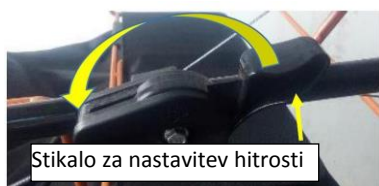
Slika 15-1 Stikalo za nastavitev hitrosti – položaj za izklop
