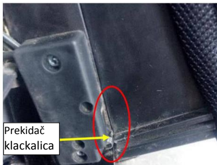
Slika 14-2 Prekidač klackalica – zatvoreno stanje
