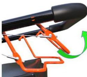
Slika 21-2 Premaknite pogonsko ročico navzgor proti ročaju
