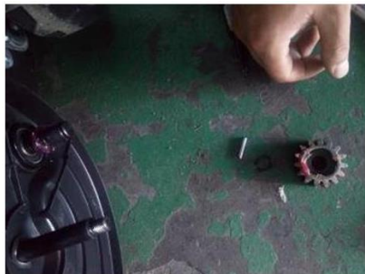
Slika 39-2 Dodajte mazivo na izhodno gred
