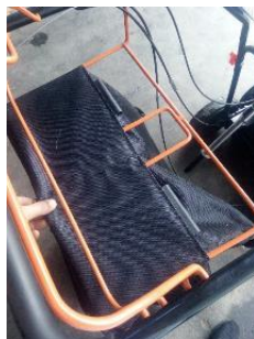
Slika 37-3 Odstranite vrečo zbiralnika
