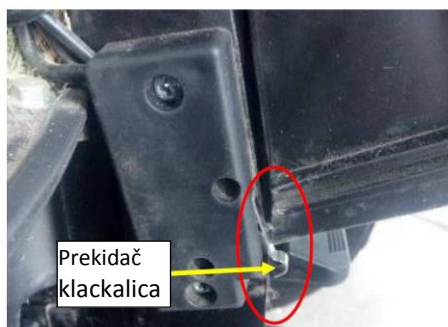
Slika 14-1 Prekidač klackalica – otvoreno stanje
