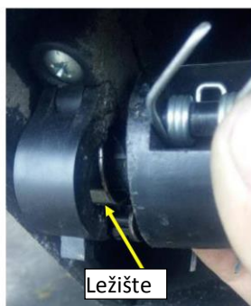
Slika 11-4 Škljocnite u ležište
