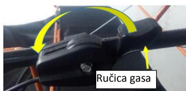
Slika 15-1 Ručica gasa – motor zaustavljen
