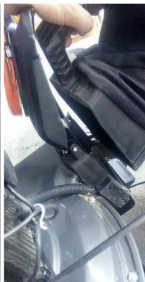
Slika 10-6 Namestite zadnji pokrov
