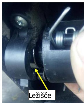
Slika 11-4 Pritisnite v ležišče
