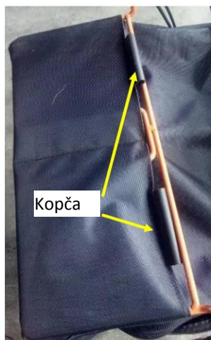
Slika 10-1 Staviti u tablu vreće za sakupljanje
