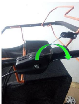
Slika 38 Položaj isključenja ručice
