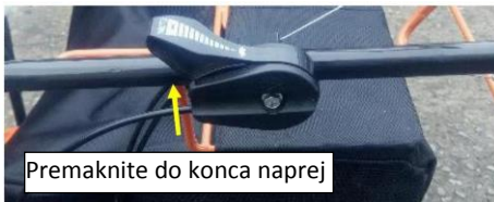
Slika 15-2 Stikalo za nastavitev hitrosti – položaj za vklop
