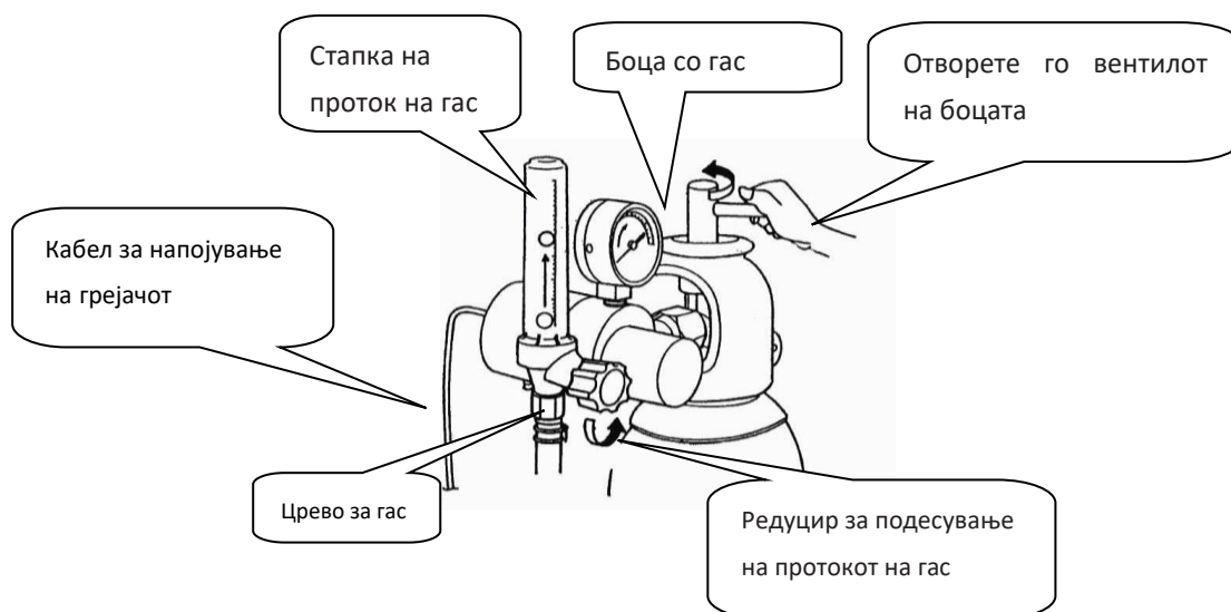
Слика 2: Отворање на вентилот за гас и подесување на протокот
